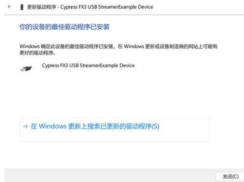
驱动自动安装完成，可以在“通用串行总线控制器”，查看是否有“Cypress FX3 USB StreamExample Device”驱动确认是否完成驱动安装。
